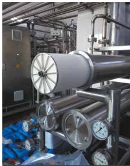
Санитарный мембранный элемент SNNF 8038-31 для сгущения сыворотки
